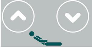
**Ascenso espaldar:** Al mantener presionada esta tecla el cabecero sube y se detiene al dejar de oprimirla o hasta que alcance la máxima altura.
