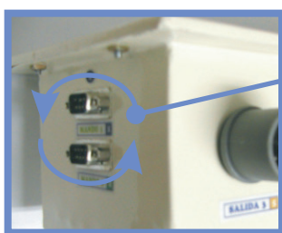
Conexiones para 2 controles de mano
