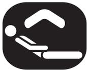
**Para ascender el espaldar:** presione la tecla correspondiente hasta llegar a inclinación deseada, al soltar la tecla la del movimiento de del espaldar interrumpe instantáneamente.
