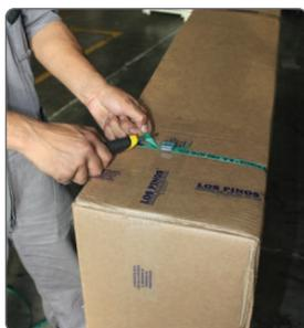
Con la caja en posición vertical y la tapa hacia arriba, corte los zunchos.
