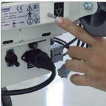
Si es requerido, utilice el terminal (pin de equipotencialidad) que permite realizar conexiones con otros aparatos para garantizar la protección contra descargas eléctricas.
